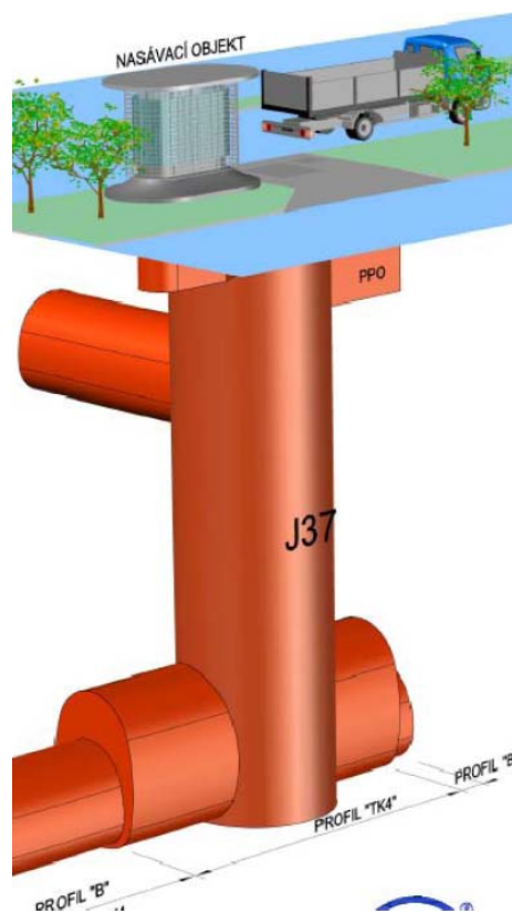
Obr. 7 Technická komora TK 4
